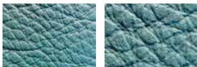
Gepigmenteerd glad leder: haar poriën zijn nauwelijks zichtbaar, er is een dikke laag verf op het leder aangebracht
